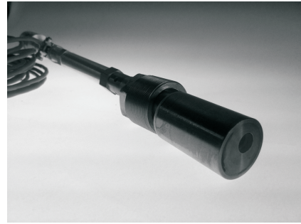
Abbildung 4.17: Lichtleiterendoskop (links) und Halter (rechts) für optischen Zugang
