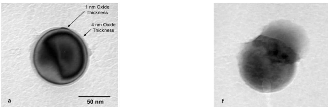
**Abb. 4.8:** Al-Si-Nanopartikel bei RT (links), Aufbrechen der Aluminiumoxidschicht bei 550 °C (rechts) (SH04)
