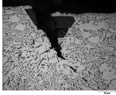
Abb. 10.10. Bruch einer oberflächennahen Siliziumausscheidung mit Mikroriss bei einer AlSi 12 -Probe
