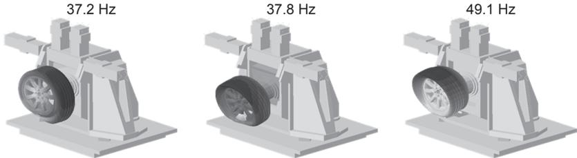
Abbildung 5.22: Komplexe Eigenfrequenzen und –formen des gekoppelten Systems Reifen-Hohlraum-Rad und Kraftschluss-Radführung Mod. 2.
