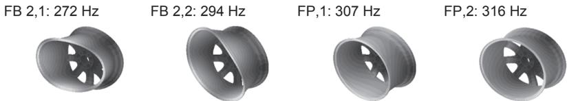
Abbildung 4.21: Darstellung der berechneten komplexen Rad-Eigenformen FB 2,1/2 und FP, 1/2 des mit ca. 60 km/h rollenden Radmodells (168 Elemente über dem Umfang).
