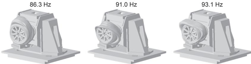
Abbildung 5.19: Komplexe Eigenfrequenzen und -formen des gekoppelten Systems Reifen-Hohlraum-Rad und Kraftschluss-Radführung Mod. 1.
