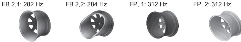
Abbildung 4.13: Eigenschwingformen des eingespannten, nicht rotierenden Rades unter 350 Hz.
