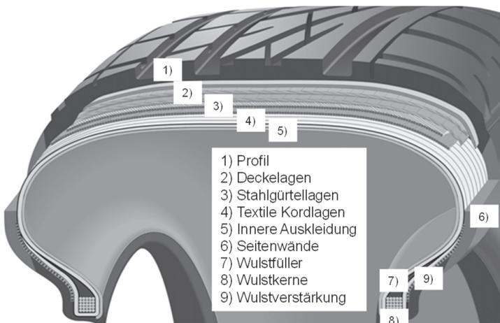
Abbildung 2.1: Exemplarischer Aufbau eines PKW-Reifens, ähnlich [Gips06], zitiert nach [Herk08].
