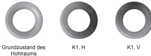
Abbildung 2.9: Darstellung simulierter Hohlraum-Eigenformen.
