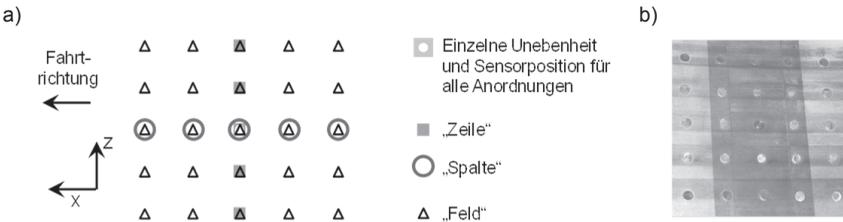
Abbildung 3.53: a) Schematische Darstellung der zusätzlichen Unebenheiten in der Umgebung des Sensors b) Photographie der Anordnung „Feld“.
