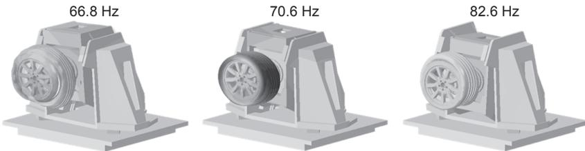
Abbildung 5.18: Komplexe Eigenfrequenzen und -formen des gekoppelten Systems Reifen-Hohlraum-Rad und Kraftschluss-Radführung Mod. 1.
