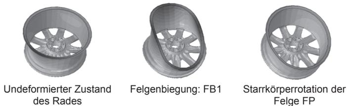
Abbildung 2.11: Benennung und Darstellung simulierter Rad-Eigenformen bis 400 Hz.
