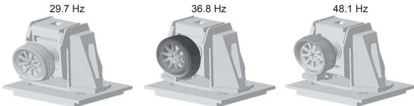
Abbildung 5.16: Komplexe Eigenfrequenzen und -formen des gekoppelten Systems Reifen-Hohlraum-Rad und Kraftschluss-Radführung Mod. 1.
