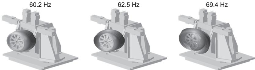
Abbildung 5.23: Komplexe Eigenfrequenzen und –formen des gekoppelten Systems Reifen-Hohlraum-Rad und Kraftschluss-Radführung Mod. 2.
