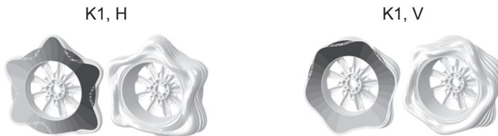
Abbildung 4.6: Realwertigen Hohlraum-Eigenformen des stehend belasteten Systems, fest eingespanntes Rad (Radlast 5 kN, Fülldruck 2.8 bar, 168 Elemente über dem Umfang, PE = 0, Kompressionsmodul  $K_f = 0.53 \text{ N/mm}^2$ ).
