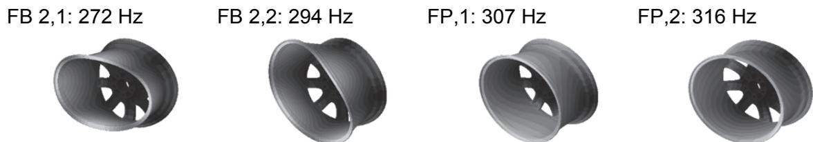
Abbildung 4.21: Darstellung der berechneten komplexen Rad-Eigenformen FB 2,1/2 und FP, 1/2 des mit ca. 60 km/h rollenden Radmodells (168 Elemente über dem Umfang).
