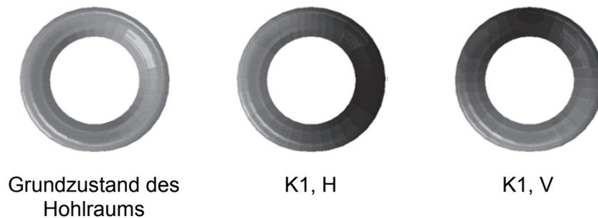
Abbildung 2.9: Darstellung simulierter Hohlraum-Eigenformen.
