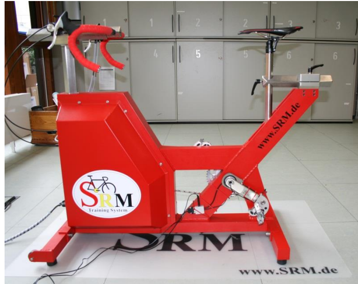
Abbildung 4: Fahrradergometer der Firma SRM am IfSS des KIT (eigenes Bildmaterial)
