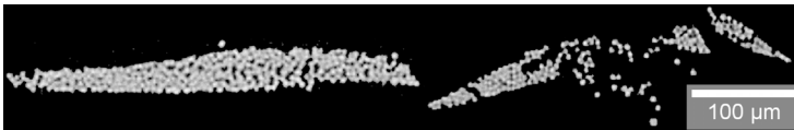
Abbildung 6.32: Dicht gepackter Roving mit 80 % Raumerfüllung (links) und aufgesplitteter Roving mit 35 % Raumerfüllung (rechts).
