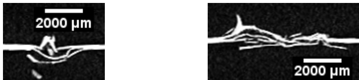
Abbildung 6.31: Fortschreitende Schädigung von Nomex-Zellwänden in der CT-Messung sichtbar gemacht. Das Schädigungsbild zeigt deutlich die Delamination der Harz- und Papierschichten beim Kraftmaximum (links) mit anschließendem Bruch oder Auffalten (rechts).
