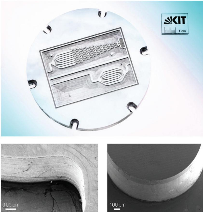
Abbildung 4.6: Formeinsatz Mikrofluidikchip zur Stammzellendifferenzierung Version Zwei. Fotografie des Formeinsatzes (oben). REM-Aufnahmen des Formeinsatzes (unten) aus dem Bereich des Mischereinflusses (links) und einer Pinstruktur (rechts)<sup>14</sup>
