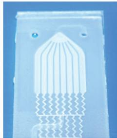
Abbildung 4.2: Abformung mit transparenter Zellkammer. a) Teilpolierte Substratplatte. b) Gebondeter Mikrofluidikchip abgeformt mit  $< 100 \mu\text{m}$  dünnen Folien unter der Zellkammer. c) Gebondeter Mikrofluidikchip abgeformt mit Stahlplättchen (Stärke  $200 \mu\text{m}$ ) unter der Zellkammer. d) Gebondeter Mikrofluidikchip abgeformt mit teilpolierter Substratplatte, die polierte Fläche befindet sich bei der Abformung unter der Zellkammer.
