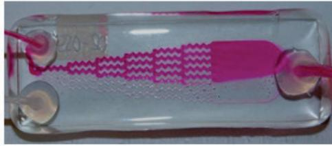
*Abbildung 5.4: Betrieb des Mikrokaskadenmischers mit zwei Zuckerlösungen bei einer Flussrate von 0,0025 ml/min. Die niederviskose, gefärbte Lösung, dringt auf die Seite der höherviskosen, transparenten Lösung vor.*
