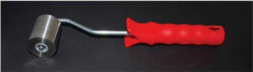
Abbildung 4.21: Zur Beschichtung der Mikrofluidikchips gefertigte Beschichtungswalze.<sup>23</sup>
