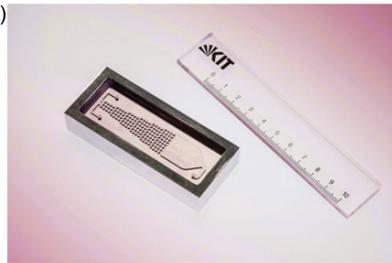
Abbildung 4.10: Formeinsatzdesigns für den Mikrofluidikchip zur Herstellung von Porngradientenfilmen. a) Aluminiumtestwerkzeug, mit dem Design des Mikrofluidikchips zur Stammzellendifferenzierung Version Zwei. b) PMMA-Prototyp mit einer durchgängigen Reaktionskammer. c) Aluminiumformwerkzeug mit Rand.<sup>15</sup>
