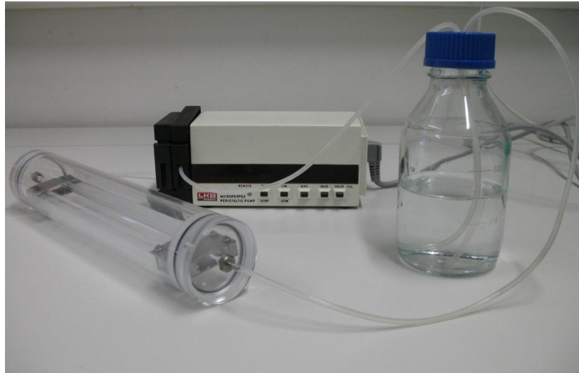
Abbildung 54: Abbildung des Röhrenreaktors. Das Medium wurde mit Hilfe einer Schlauchpumpe durch die Auffangflasche und die Röhre mit den Glasoberflächen gepumpt.
