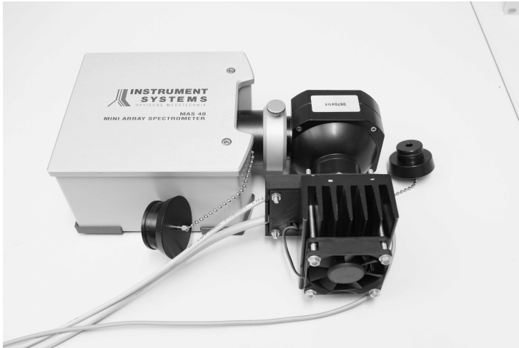
Abbildung 4.5.: Spektrometer MAS 40 mit vorgelagerter U-Kugel, in der sich das Singlechip-System befindet.
