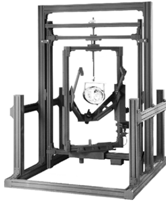
Abbildung 3.8.: Das Nahfeldgoniophotometer Rigo801 [38]. Der innere Rahmen fährt den Winkel \gamma ab, während der äußere Rahmen mit dem \phi Winkel die C-Ebene schwenkt.
