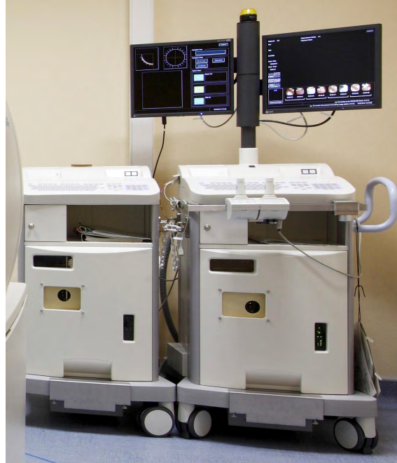
Abbildung 4.4: Image and Guidance Display: Diese Workstation speichert die Untersuchungsdaten und bietet die grafische Benutzeroberfläche für die MGCE mit Darstellung der Echtzeitbilder der Kapsel.
