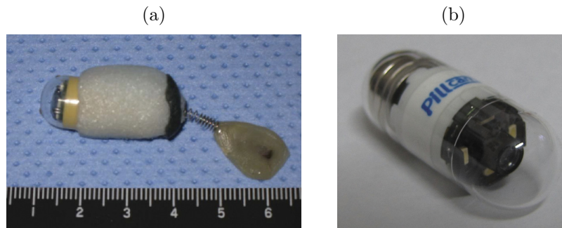
Abbildung 3.4: Zwei Ansätze unterstützt von Given Imaging für Kapselendoskopie im Magen: (a) Kapsel mit Permanentmagnet in einer Flosse [107], (b) Kapsel mit integrierten Magneten an einem Ende zur Führung mit Handmagneten [136]
