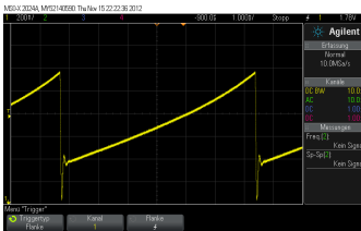
(a) An einem Oszilloskop aufgenommenes Sägezahnsignal mit dem der VCO des Sensors moduliert wird
