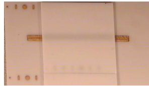
(b) Schrägansicht der doppelten Flip-Chip-Verbindung
