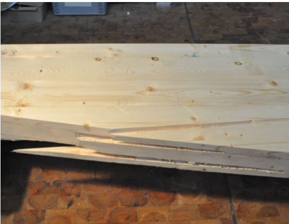
Bild 3-13 Prüfkörper RU 900/1 – Versagen am Rand schräg zur Faserrichtung
