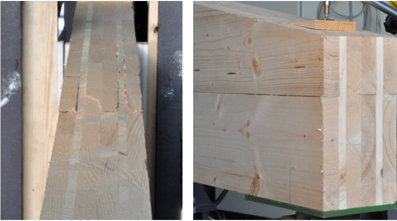
Bild 3-12 Prüfkörper RO 900/5 – Schubversagen am Rand schräg zur Faser- richtung (links) und am unteren Rand der obersten über die gesamte Länge durchlaufenden Brettlamelle (rechts)
