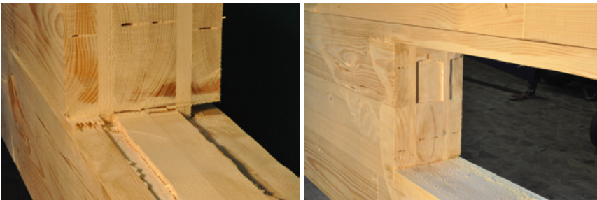
Bild 3-24 Schubversagen in den Kreuzungsflächen bei Prüfkörper DB 600/300-4 (links) und Prüfkörper DB 600/240-3 (rechts)
