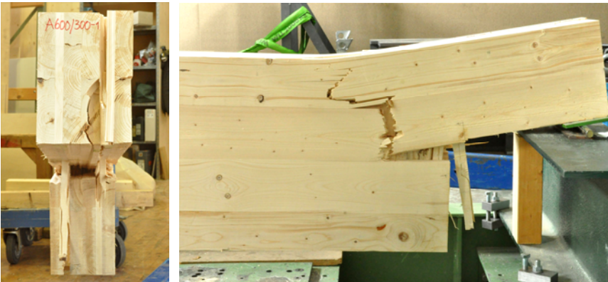
Bild 3-31 Schubversagen in den Kreuzungsflächen neben der Ausklinkung bei Prüfkörpern A 600/200-1 (links und rechts)
