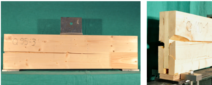
Bild 3-34 Schubversagen in den Kreuzungsflächen an den Auflagern bei den Prüfkörpern Q 300/95-3 (links) und Q 300/110-1 (rechts)
