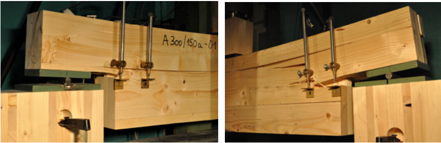
Bild 3-30 Schubversagen in den Kreuzungsflächen neben der Ausklinkung bei den Prüfkörpern A 300/100-1 (links) und A 300/110-4 (rechts)
