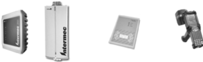
Abbildung 2.8: Varianten für Schreib-/Lesegeräte. Stationär: Intermec-Lesegerät und externe Antenne (links), deister Tischgerät als Lesegerät mit integrierter Antenne (Mitte). Mobil: Motorola Handheld als Lesegerät mit gekoppelter Antenne (rechts). Quelle: Intermec, deister, Motorola
