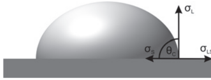
Abbildung 4.1: Definition des Kontaktwinkels \theta_C zwischen einer Flüssigkeit und einer Festkörperoberfläche.
