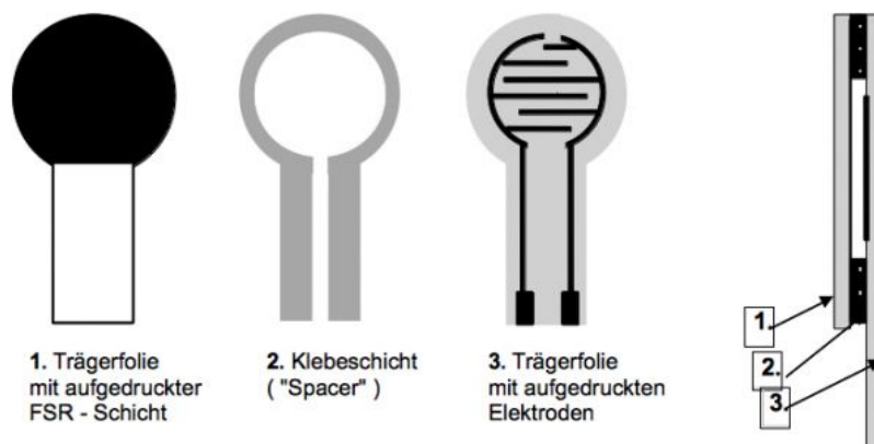
Abbildung 5.3: Aufbau eines Folienkraftsensors (FSR)
