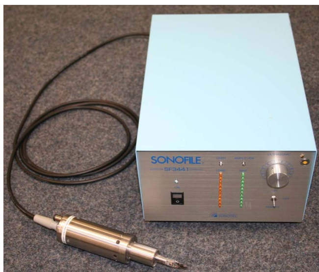
Abbildung 5.3: Ultraschallmesser der Firma Sonotec [48]
