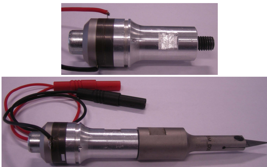
Abbildung 5.4: Piezoelektrischer Konverter und gesamte Struktur für die experimentelle Untersuchung - Oben: Piezoelektrischer Konverter. Unten: Konverter mit Sonotrode und Klinge
