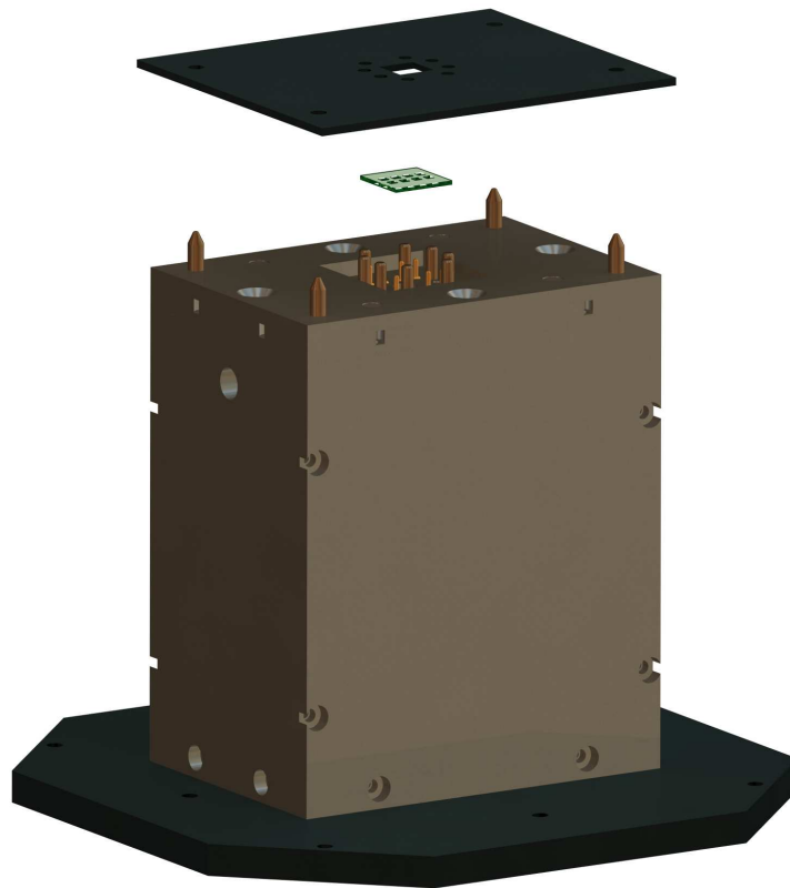
Abb. 4.1.2: Haltersystem zur reproduzierbaren Kontaktierung der Solarzellen bei EQE und J – V -Messungen. Die Solarzelle wird zur Charakterisierung in den Halter eingelegt. Dabei dienen die um die Solarzellenposition angeordneten acht Stifte (bronzefarben) als Führung. Die Blende wird von oben auf den Halter aufgesteckt. Darin eingelassene Magnete erzeugen den nötigen Anpressdruck, um die Solarzelle (grün) gegen die Federkontaktstifte (gold) zu drücken. Blende und Bodenplatte sind glasperlengestrahlt und schwarz eloxiert um Reflexionen zu vermeiden.
