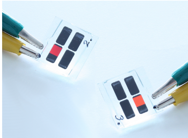
Abb. 6.3.9: Fotografie der im Text beschriebenen verkapselten SiLEDs, welche an eine 9 V-Batterie mit regelbarem Vorwiderstand angeschlossen wurden. Aufgenommen wurden die SiLEDs unter Umgebungsbedingungen bei normalem Tageslicht.
