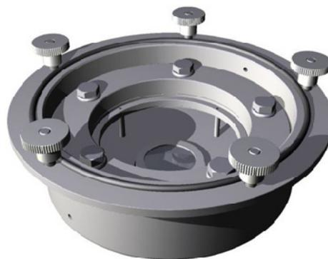
Abb. 5-6: modifizierte Radondiffusionskammer
