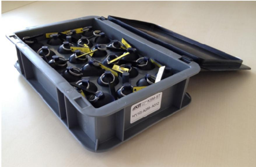
Abb. 5-4: Aufbewahrungssystem H\*(10) Kugeldosimeter
