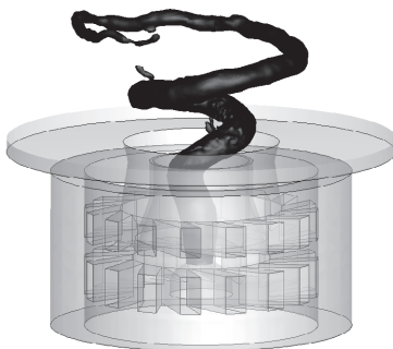
Abbildung 10.27.: Visualisierung des PVCs im Düsenmund über eine Isokontur des statischen Druck bei p = 9,7e - 4
