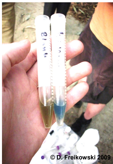
Abb. 11: Qualitativer Nachweis von Saccharose nach Whitehead und Bradbury (1950). Unter alkalischen Bedingungen wird in Anwesenheit von Saccharose mit \text{Co}(\text{NO}_3)_2 ein Co-Saccharose-Komplex gebildet, der als blauer Niederschlag ausfällt.
