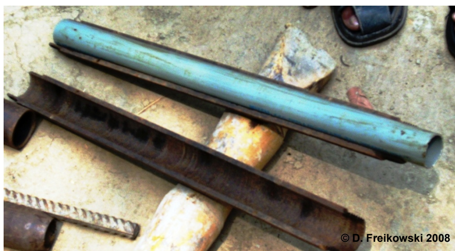
Abb. 8: Bohrgestänge mit enthaltener PVC-Röhre. Die PVC-Röhre wurde vor der Probenahme sterilisiert und unmittelbar nach der Entnahme mit N_2 begast, mit Plastikkappen verschlossen und versiegelt.
