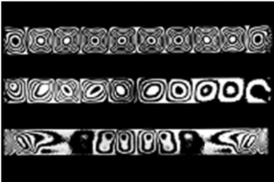
**Abb. 3.21** Einfluss der Scherströmung und Rotation auf die thermische Zellularkonvektion
