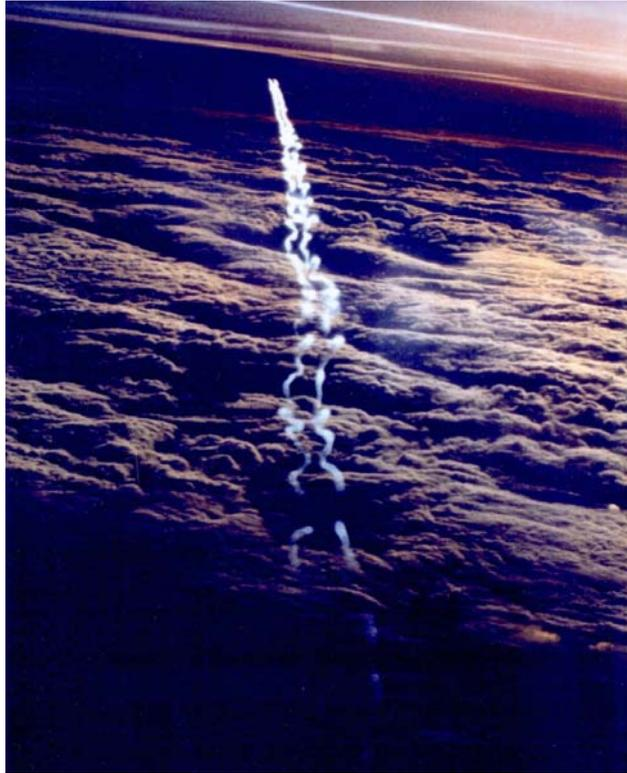
**Abb. 3.16** Nachlaufströmung eines Verkehrsflugzeuges
