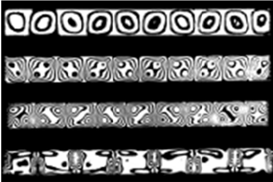
Abb. 3.19 Differenzialinterferogramme der thermischen Zellularkonvektion
