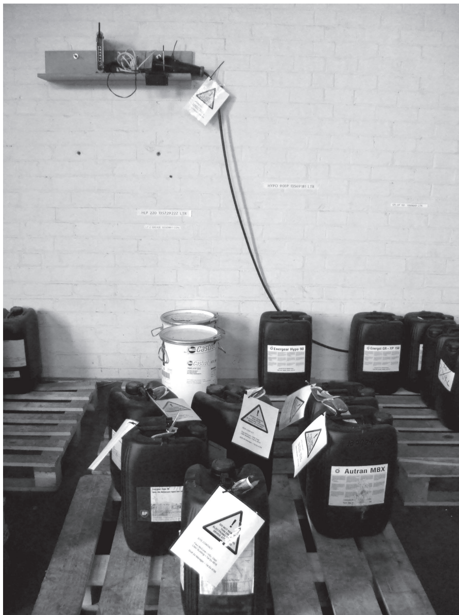
Abbildung 40: Verbindung zu Backend-System über 2.4Ghz WiFi mit linux-basierten Gateway auf MIPS-Basis
