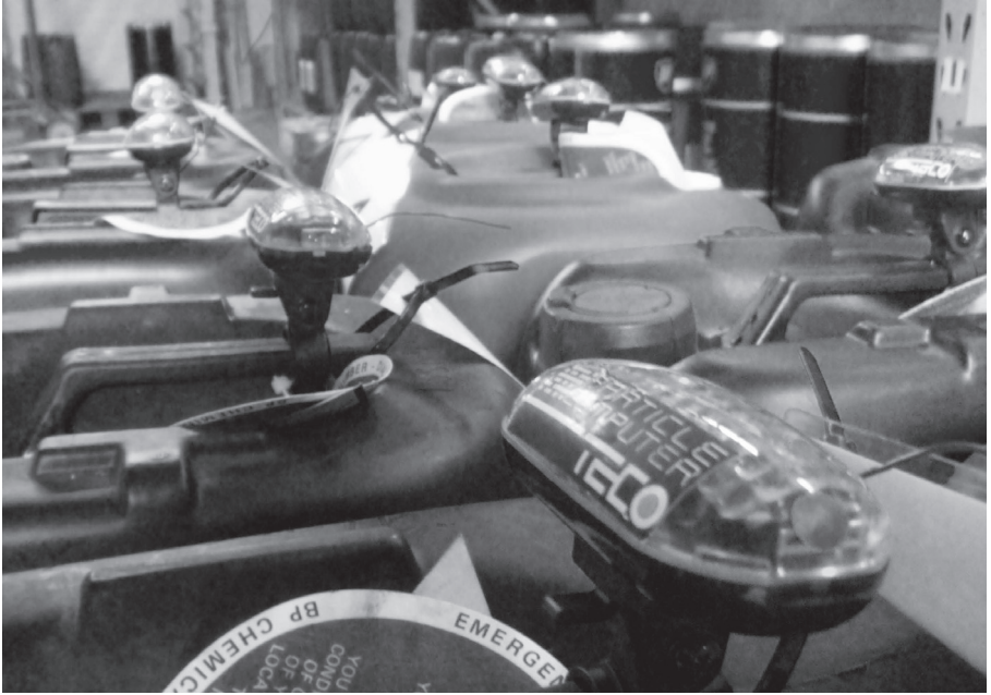
Abbildung 4: pPart Sensorknoten integriert in ein System zur Überwachung von chemischen Gütern aus [Riedel et al., 2007]
