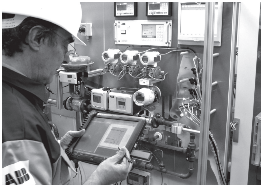
Abbildung 71: Testinstallation beim Projektpartner mit ad hoc ausgebrachten Sensorknoten und mobilem Client
