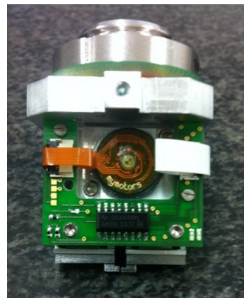
Abb. 36: Elektrischer Zweifingergreifer mit integrierter Steuerungselektronik
