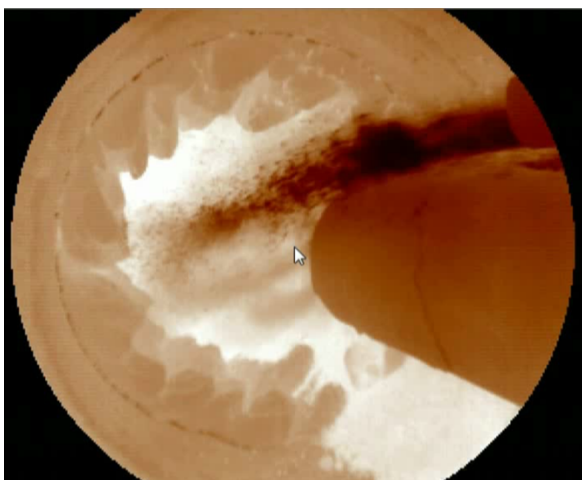
Abb. 2 Infrarotbild eines Multi-Fuel-Brenners beim Einsatz von Ersatzbrennstoffen
