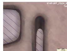
Abb. 34: Teilausschnitt der homogenen Abdichtung zum Substrat
