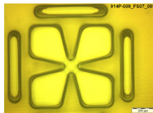
Abb. 33: Flächig verklebtes mikrostrukturiertes Polymerbauteil
