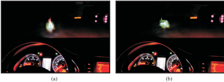
Abbildung 1.1: Lichtbasierte Markierung von Objekten im Verkehrsraum. Links: Zu erkennen ist die Markierung eines Menschen (hier: Objektklasse » Mensch «). Rechts: Zu erkennen ist die Markierung eines Rehzeichens in Form eines Rehs (hier: Objektklasse » Reh «).
