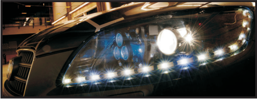
Abbildung 4.19: Technische Realisierung der markierenden Lichtinstanz als integrative Einheit im Versuchsfahrzeug AUDI Q7 - zu erkennen sind drei autonome Lichtmodule: (a) Xenon-Projektionsmodul für die Grundlichtverteilung; (b) Markierendes Licht; (c) Tagfahrlicht; (Bildquelle: Breig/ KIT).
