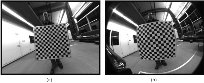
Abbildung 2.6: Links: Extreme radiale Verzerrung durch Weitwinkelobjektiv. Rechts: Kompensation der radialen Verzerrung durch Berücksichtigung der intrinsischen Parameter (Linsenverzerrung) nach Kalibrierung/ Rektifizierung.
