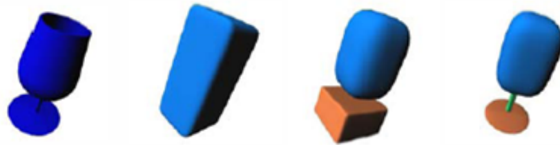
Abbildung 2.8: Schrittweise Approximation eines Weinglases (ganz links) durch einen Binärbaum aus Superquadriken. Nachdruck aus [Goldfeder 07], ©IEEE 2007
