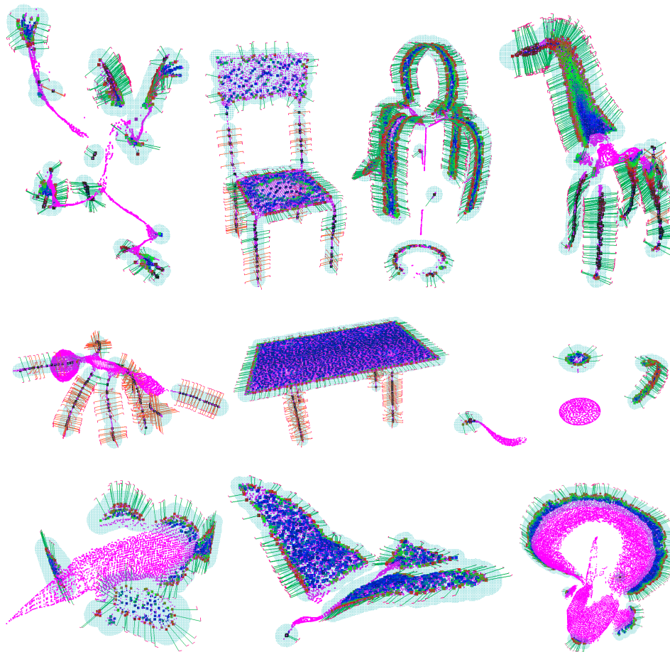
Abbildung 4.10: Generierte Griffkandidaten für die in Abbildung 4.9 betrachteten Objekte. Die Griffkandidaten sind als Linien abgebildet, welche die jeweilige Anrückrichtung P_a der Hand repräsentieren. Griffkandidaten, die von lokalen Symmetrieebenen herkommen, sind als grüne Anrückrichtungen eingezeichnet, während Griffkandidaten, die von lokalen Symmetrieachsen herkommen, als orangene Anrückrichtungen eingezeichnet sind. Die Handorientierung P_o eines Griffkandidaten wird jeweils durch eine kurze magentafarbene Linie am Ende einer Anrückrichtung angedeutet. Rosa Punkte repräsentieren die Mittelpunkte derjenigen Kugeln, die zu groß sind, um mit der ARMAR-III-Hand gegriffen zu werden. Abbildungen für Fisch, Ameise, Vogel: Nachdrucke aus [Przybylski 11a], ©2011 IEEE
