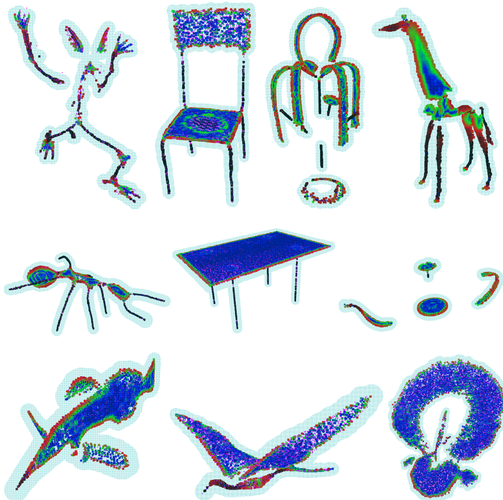
Abbildung 4.9: Ergebnis der Symmetrieanalyse für weitere Testobjekte. Farbgebung wie in der vorigen Abbildung, abhängig von \rho_N . Alle Kugeln haben einen Objektwinkel von mindestens 120^\circ . Es wurde nicht nach Kugelradien gefiltert. Längliche Objektteile sind meist schwarz (sehr kleine Werte von \rho_N ), die Ränder lokaler Symmetriefflächen sind rot (weisen kleine Werte von \rho_N auf), die Symmetriefflächen ändern ihre Farbe von den Rändern zum Inneren hin über gelb und grün zu blau (große Werte von \rho_n ). Reihenfolge der untersuchten Objekte von links oben nach rechts unten: Spielzeugmonster-Actionfigur, Stuhl, Amphore, Giraffe, Ameise, Tisch, Teekanne, Fisch, Vogel und Büste.
