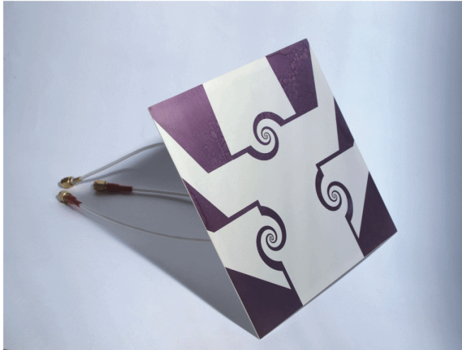
Abbildung 4.16.: Fotografie einer Testplatine zur messtechnischen Charakterisierung von log-Spiralantennen im Mikrowellenbereich [78].
