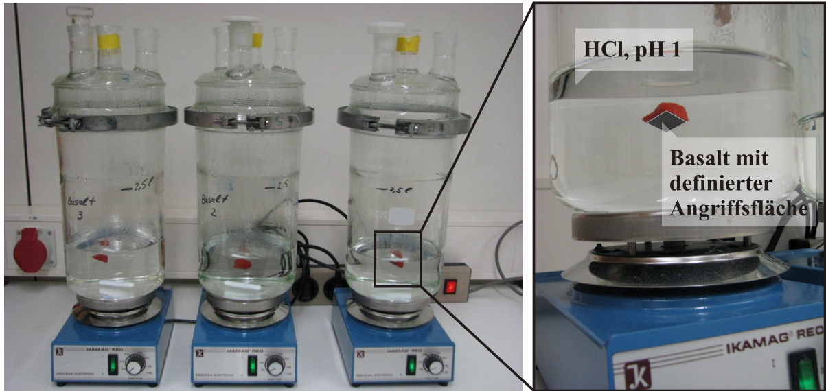
Abb. A3-35: Versuchsaufbau zur Untersuchung der flächenbezogenen CaO-Auslaugung von Basalt (Körnung 5/8 mm) beim Angriff von HCl, pH 1
