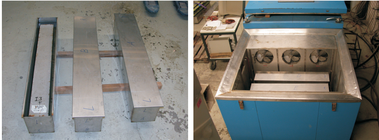
Abb. 3-44: Balken (1000/125/125 mm) in den Prüfbehältern vor der Befrostung (links) und Prüfbehälter in der Klimatruhe (rechts)
