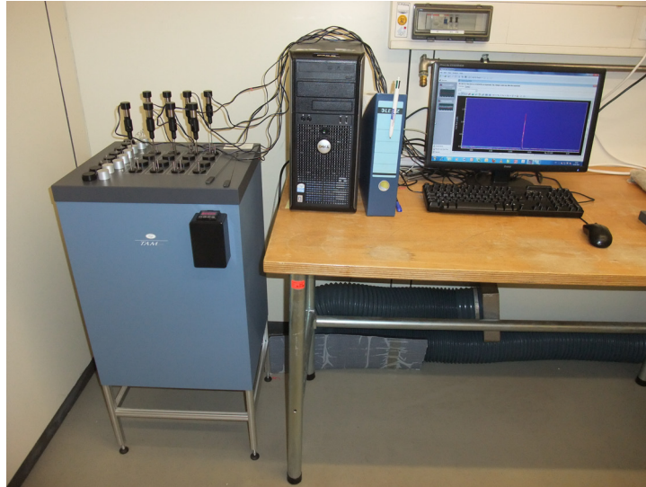
Abb. 3-5: Isothermes Wärmeleitkalorimeter zur Erfassung der zeitlichen Entwicklung des Hydratationsgrads
