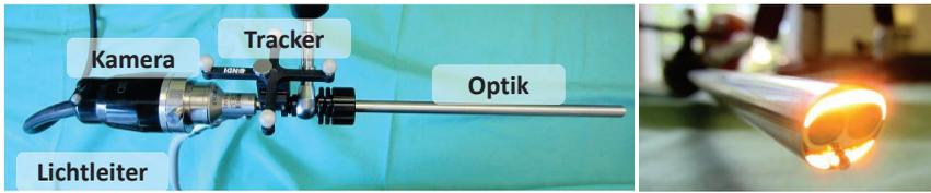
Bild 2.4: Aufbau eines Stereo-Endoskopes (mit optionalem Tracker zur Verfolgung der Position durch ein Trackingsystem)
