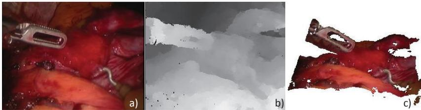
Bild 1.2: Oberflächenrekonstruktion aus Bildern eines Eingriffes mit dem daVinci-Teleskopmanipulator: a.) Linkes Kamerabild; b.) Disparitätsbild, das die Entfernung eines Punktes als Grauwert kodiert; c.) rekonstruierte Punktwolke
