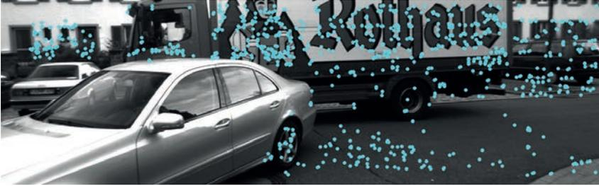
**Abbildung 4.15:** Liegt ein Großteil der detektierten Merkmalspunkte auf einem einzelnen unabhängig bewegten Objekt, führen die Merkmale eine konsistente Bewegung durch. Die Eigenbewegungsschätzung liefert in diesem Falle schlechte Ergebnisse, da nicht die Punkte auf der statischen Umgebung sondern die Punkte auf dem Objekt die beste Hypothese innerhalb des RANSAC-Algorithmus liefern.
