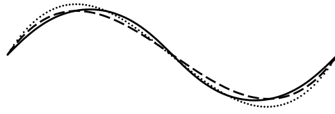
Abbildung 3.5: Numerische Lösung (durchgezogen) der exakten DGL, nachträgliche Spline-Approximation (gestrichelt) der numerischen Lösung und vorgeschlagene Spline Approximation (gepunktet)
