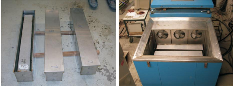
**Abb. 3-44:** Balken (1000/125/125 mm) in den Prüfbehältern vor der Befrostung (links) und Prüfbehälter in der Klimatrufe (rechts)
