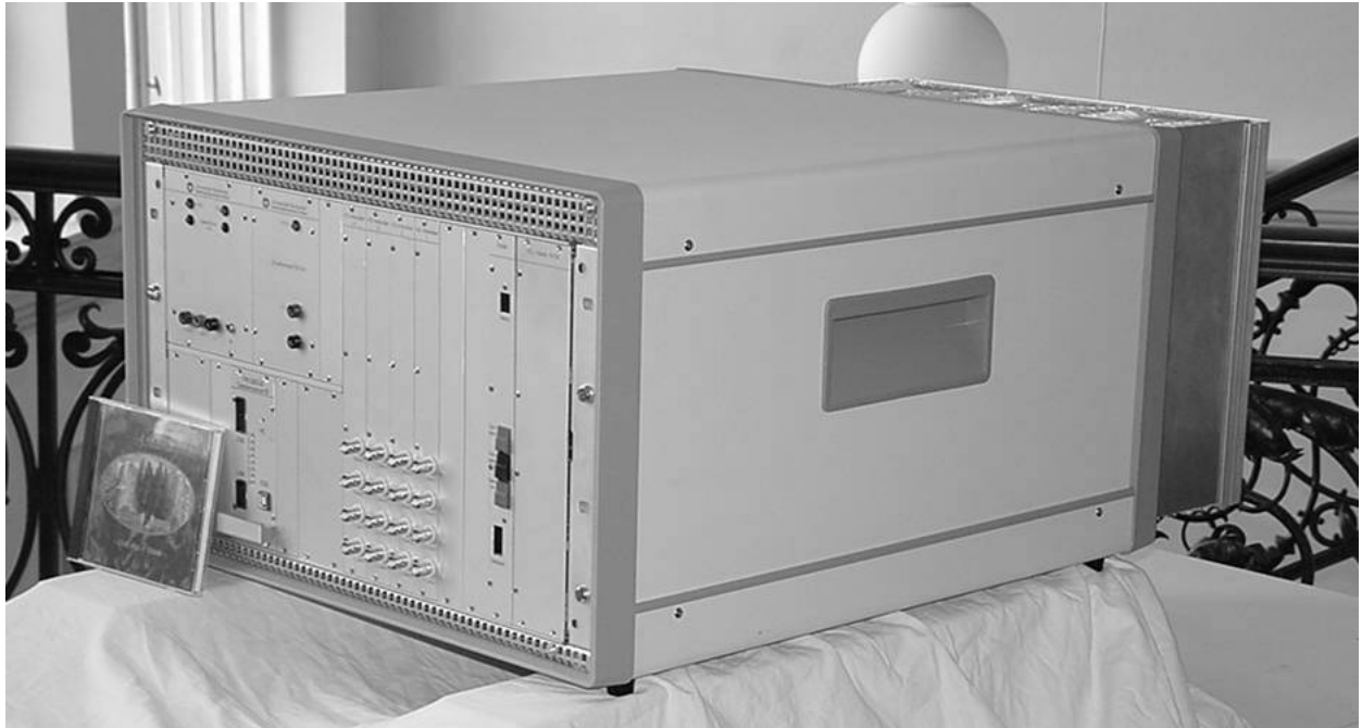
Bild 2.5: Wechselrichter - hinten der Kühlkörper, der die Wechselrichterbrücke trägt, vorne die Einschubkarten der Signalverarbeitung.
