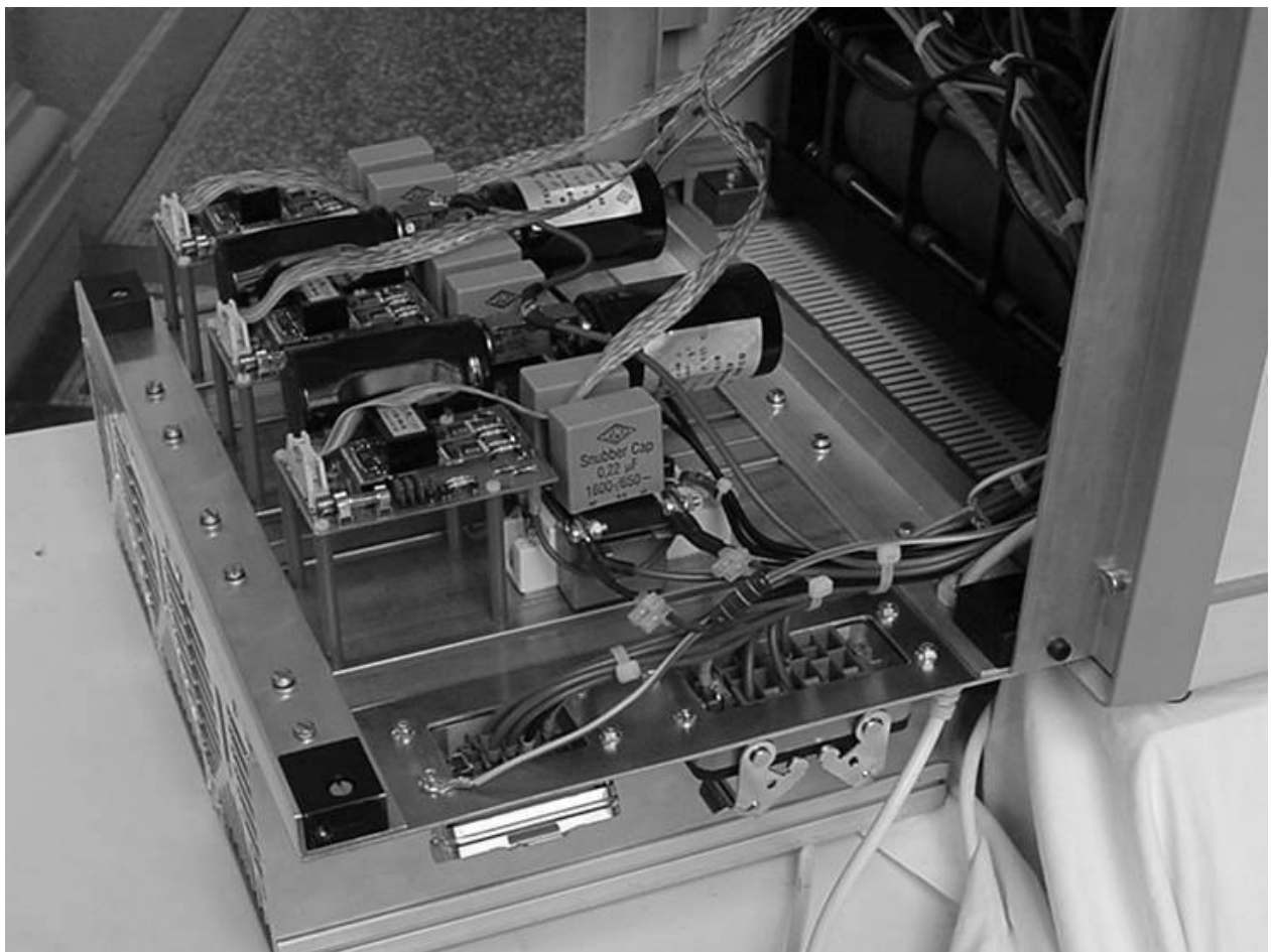
Bild 2.3: Wechselrichterbrücke (Kühlkörper ist zur Demonstration abgeklappt)
