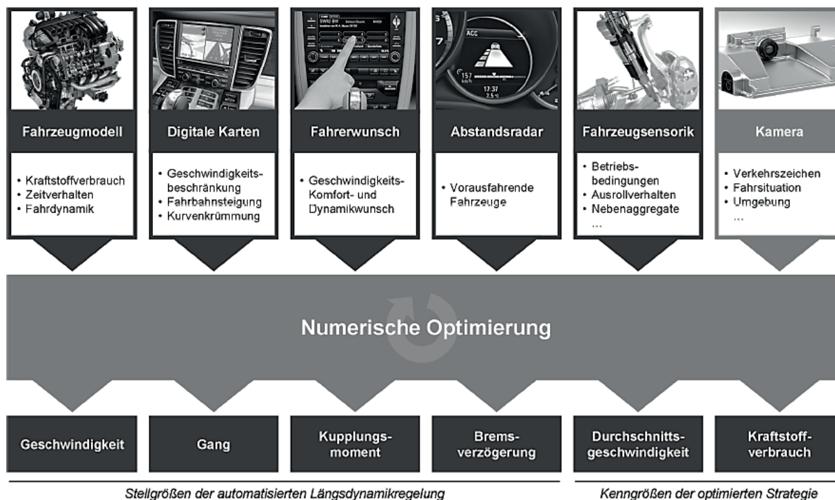
Abbildung 2-26: Schematischer Aufbau des FAS ACC InnoDrive der Porsche AG, welches den Fahrer unterstützt kraftstoffsparend zu fahren. Numerische Optimierung der Fahrstrategie 221
