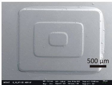
Abbildung 32 Dreidimensionale Struktur, hergestellt in Direktlithographie aus Accura 60 (Rasterelektronenmikroskopaufnahme). Die drei aufeinander liegenden rechteckigen Schichten sind jeweils 50 \mu\text{m} dick.
