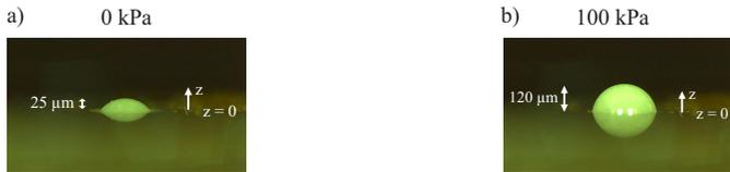
**Abbildung 5.5.:** Bewegung des sphärischen Ventilstößels in z-Richtung innerhalb des weichmagnetischen Anschlags bei einer Druckdifferenz von 0 und 100 kPa.
