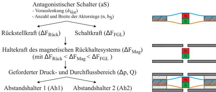
**Abbildung 5.20.:** Ablaufplan zur Steigerung des Druck- und Durchflussbereichs.
