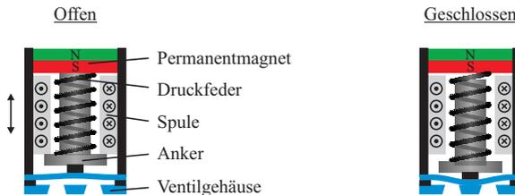
**Abbildung 3.11.:** Bistabiles Mikroventil aus Silizium mit einer externen, dreidimensionalen Spule zum Schalten. Die stabilen Zustände sind über magnetostatische Haltekräfte und eine Druckfeder realisiert [137].
