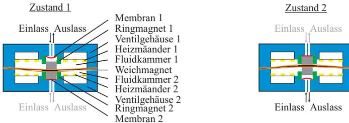
**Abbildung 3.9.:** Thermopneumatisches 3/2-Wege Mikroventil mit bistabilen, magnetostatischen Zuständen [131].
