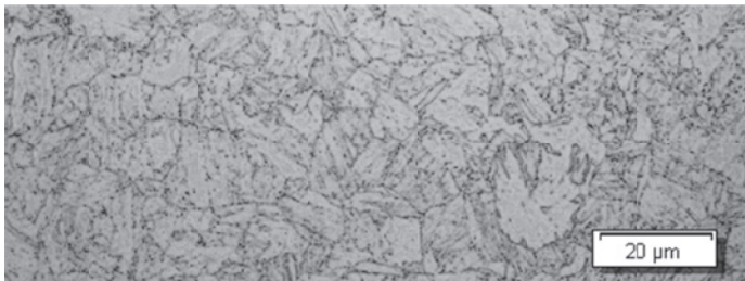
Abb. 3.2: Schlibfbild des Substratwerkstoffes S690QL bei 1000facher Vergrößerung nach Ätzung mit Nital
