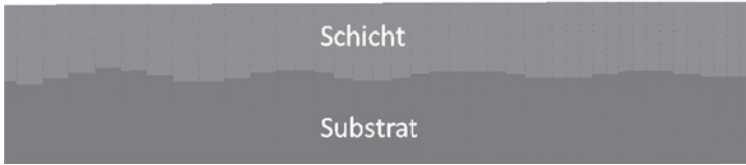
Abb. 5.18: Modellierung des Interfaces in der FE-Simulation. Das Interface wird treppenförmig angenähert
