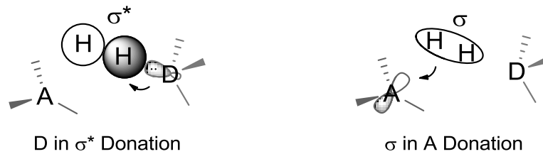
Abbildung 6: Orbitalwechselwirkungen im ÜZ der H_2 -Aktivierung erklären die nichtlineare Geometrie.
