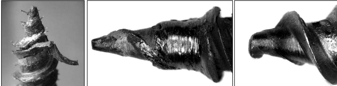
Abbildung 67: Versagensbild der LSS (Gewindes und Schraubenspitze) weist auf mindestens ein WFP im Einschraubprozess hin
