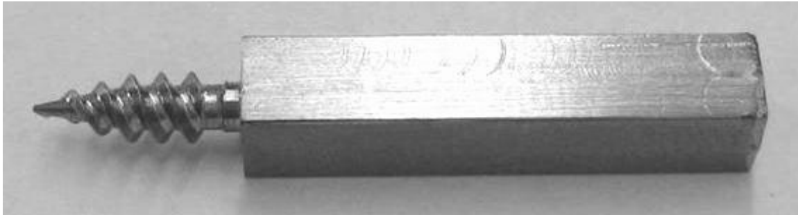
Abbildung 85: mikrogefräster Schraubenprototyp zur Bestimmung der Verknüpfung zwischen Gestalt- und Funktionseigenschaften
