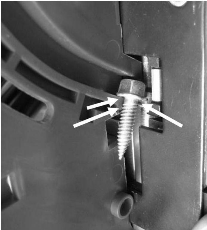
Abbildung 50: Identifizierung der WFP zwischen Schraube und Magazin
