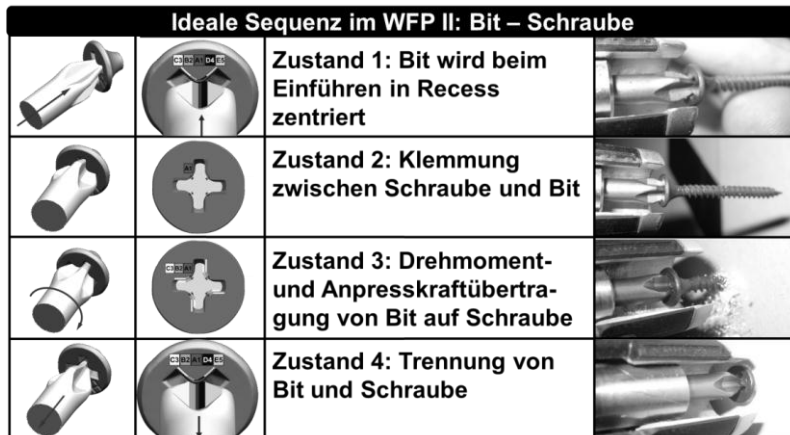
Abbildung 37: ideale Sequenz am WFP II - zwischen Bit und Recess 304
