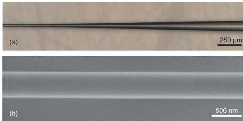
Abbildung 3.4: (a) Lichtmikroskopische Aufnahme einer ausgedünnten Glasfaser. Zu Demonstrationszwecken wurde der Verjüngungswinkel sehr steil gewählt. (b) REM-Aufnahme des dünnsten Bereichs einer Glasfasertaille. Der Minimal-Durchmesser beträgt hier etwa 450 nm.
