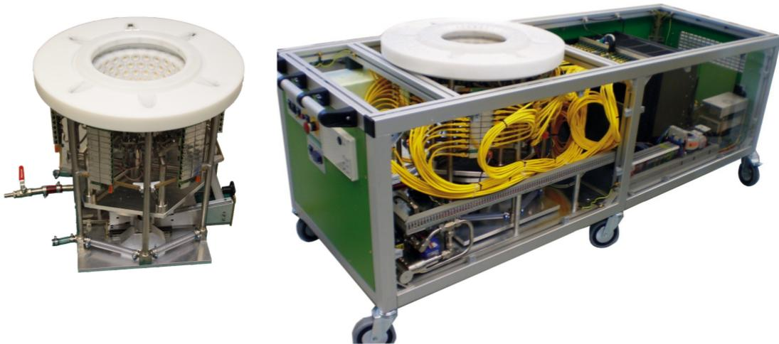
**Abbildung 2.2** – Apertur des 3D-USCT II (links) und Gesamtansicht des geöffneten Systems (rechts).
