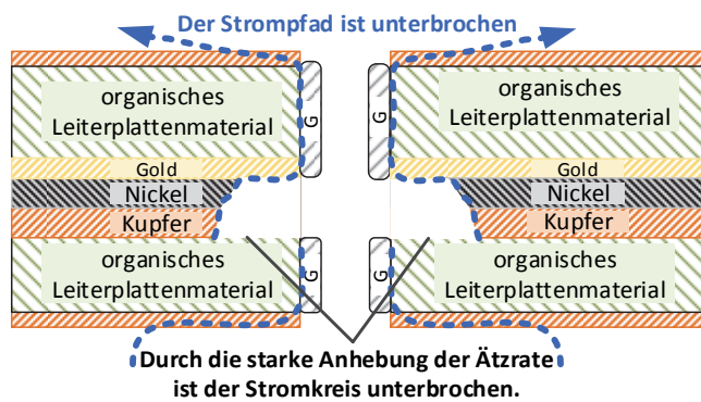
Bild 4-18: Unterätzung einer Leiterplatte mit Ni-Au Schichten nach dem Mikroätzschritt
