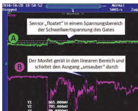
Bild 3-14: Steuer- und Ausgangssignal eines Mikrovibrationssensorsystems mit Mosfet
