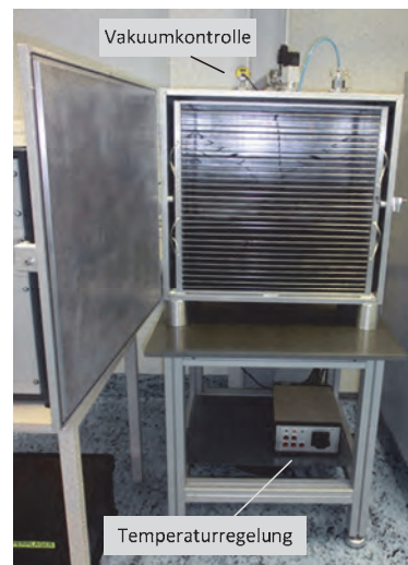
Bild 4-30: Vakuum-Trockenschrank mit 30 Einlegeböden und Temperaturregelung
