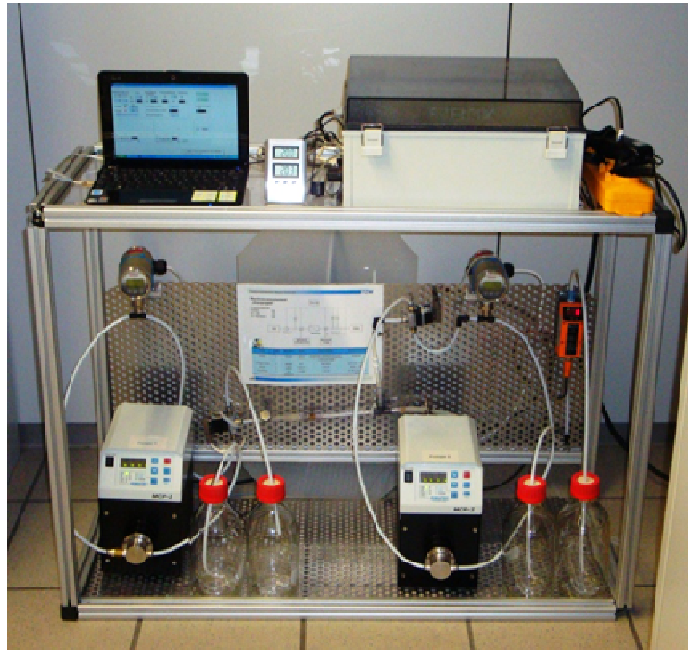
Abb. 15 Oben: Vereinfachtes Anlagenschema der Labor-Membrananlage. Unten: Laboranlage.
