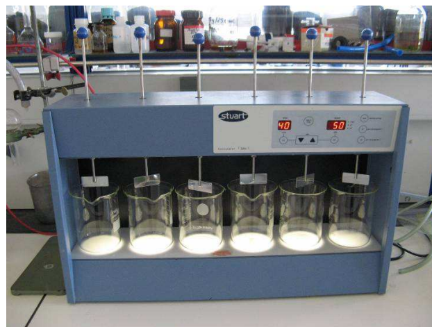
Abb. 13 Flocculator SW6 zur Durchführung der Flockungsversuche.
