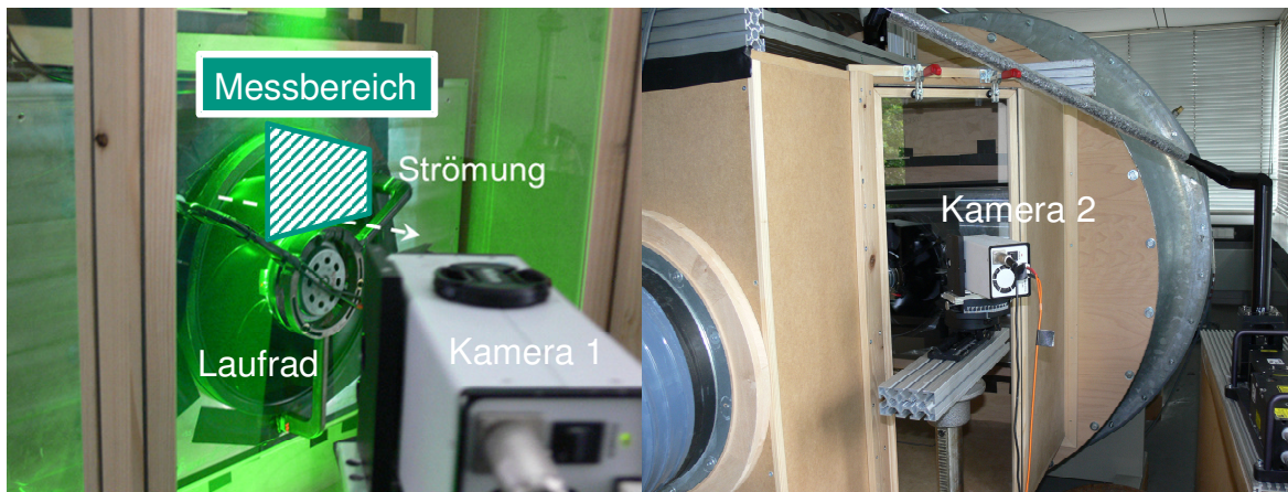
Abbildung 3.5: Teststrecke mit Kamera-Positionen und Laserführung
