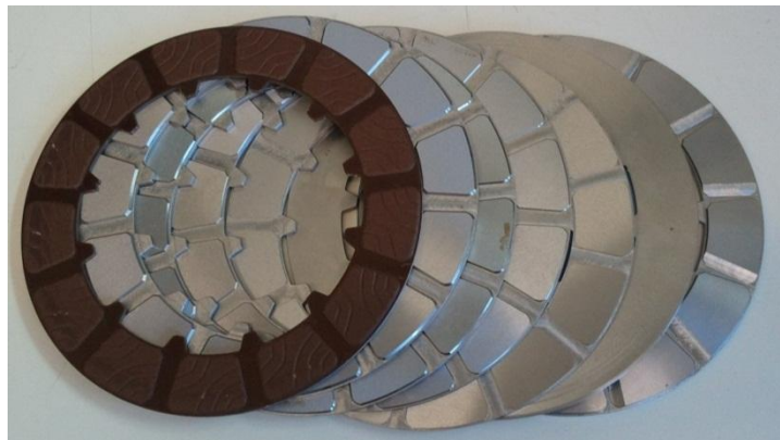
Abbildung 115: auf der neuen Entwicklungsumgebung vermessene Lamellen; von links nach rechts: Original-Lamelle, gefräste Lamellen ohne Belagsnutzung von h=1\ \text{mm} , h = 0,75\ \text{mm} ; h = 0,5\ \text{mm} ; h = 0,25\ \text{mm} ; blanke Stahllamelle, Erfindungslamelle
