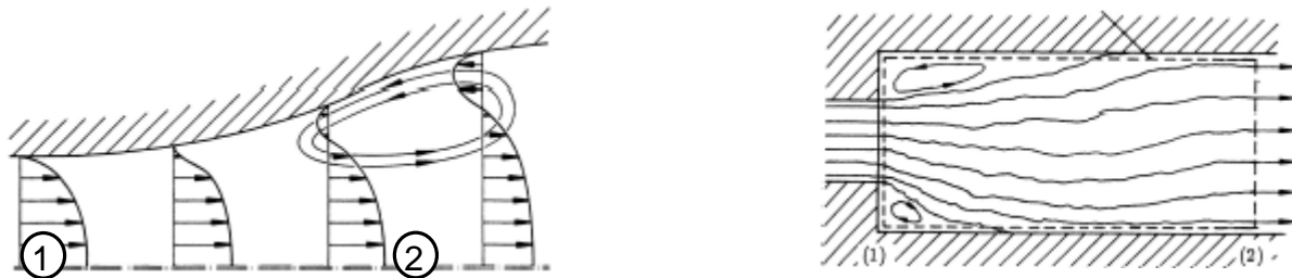
Abbildung 38: links: Diffusor mit großem Winkel und entstehender Wandablösung, rechts: plötzliche Rohrquerschnittserweiterung [Spu06]
