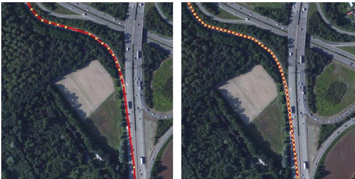
Abbildung 45: Auszug der GPS-Aufzeichnung auf ein Satellitenbild: links: original Aufzeichnung, rechts: interpolierte Daten {Ern13}
