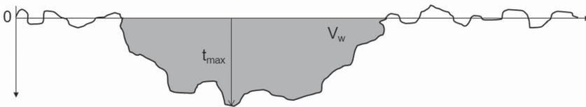
Abbildung 3.4: Ermittlung des Verschleißvolumens.
