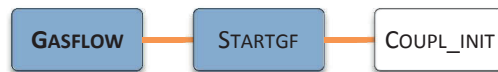
Bild 4-6: Hierarchische Übersicht über Routinen aus dem Bereich der problemunabhängigen Initialisierung. Die Routine STARTGF wurde verändert. COUPL_INIT ist eine neue Kopplungsroutine.
