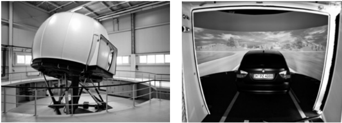
Bild 3.2.: Der dynamische Fahrsimulator (Quelle: BMW Group)
