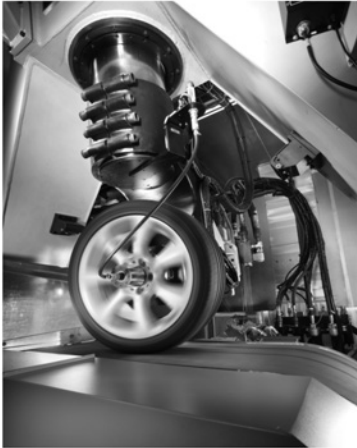
Bild 5.1.: Betriebsbereich des Flachbahnreifenprüfstands MTS FlatTrac III CT (Bild: IABG)
