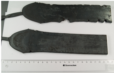
(a) Risse an den Kapselaußenseiten einer Oxidverstärkten Legierung (oben) (b) Fertige Materialien nach dem Warmumformen
