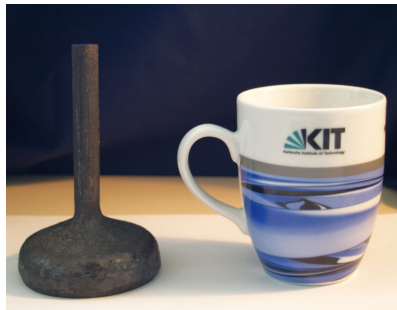
Bild 3.8.: Nicht-gepresster Teil der Extrusionskapsel
